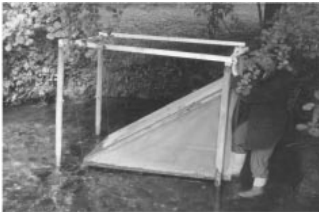
Abb.6: Das 1-2cm über der Wasseroberfläche „schwebende“ Emergenzzelt
