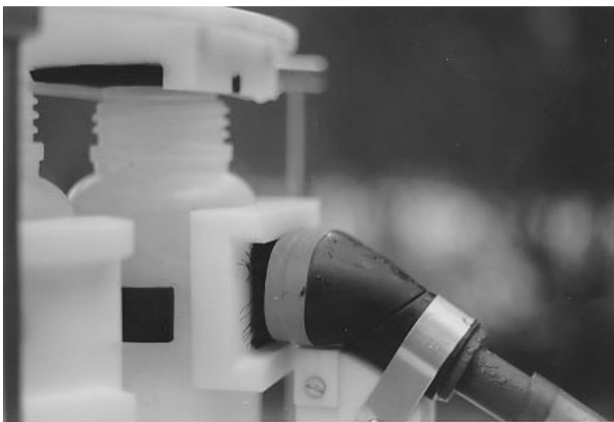
Abb.16: Saugstutzen mit Borstenrand am Auffangbehälter; links oben schwarze Schaumstofflage zur Abdichtung zwischen Fangbehälter und des zur Lampe führenden Schlauches
