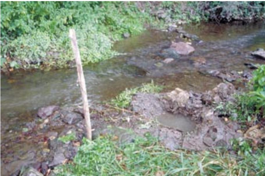
Abb. 2-2: Karaman-Chappuis-Grabung in einer Kiesbank eines Baches in Luxemburg
