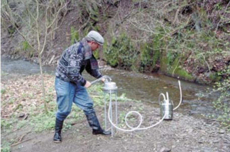
**Abb. 2-3:** Die modifizierte Interstitialpumpe nach Bou-Rouch im Einsatz an einem Bach in Luxemburg.
